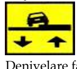
Denivelare față de banda alăturată
