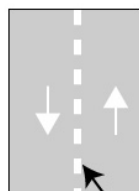
Axul drumului coincide cu axa de simetrie a drumului.
